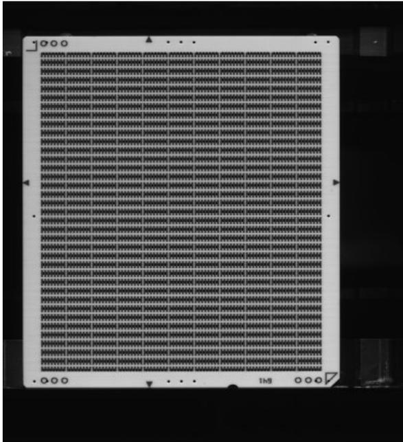
(a)晶片電阻陶瓷基板影像
