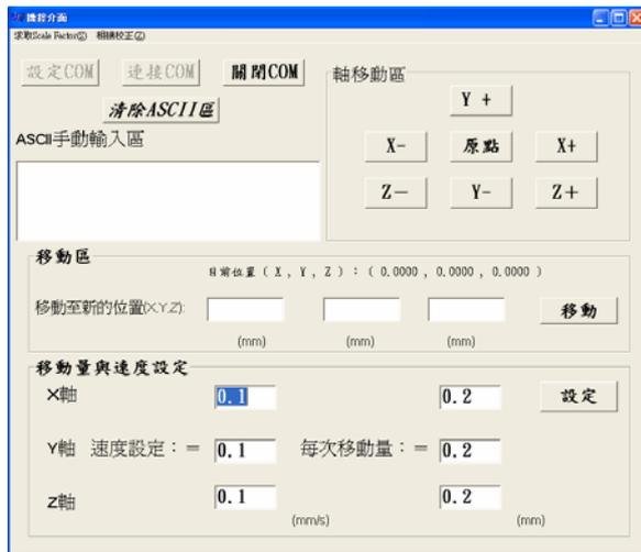
圖5 COM連接成功後的三軸平台控制介面
