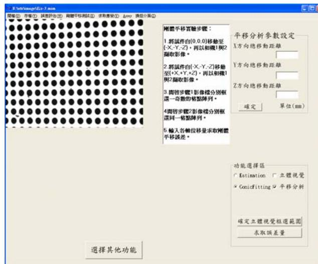
圖 17 剛體平移測試介面
