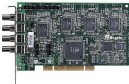
圖 2：ADLINK PCI-RTV24/Multi-Channel 影像擷取卡
