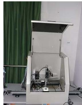
圖 3：包含 CCD 鏡頭三軸調整架之檢測機構平台
