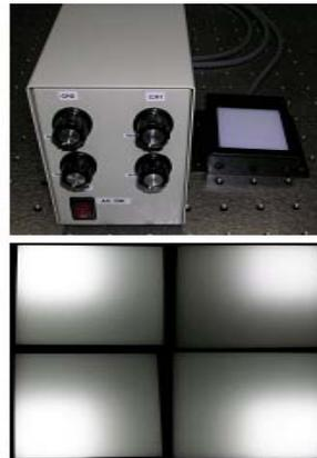
圖 3：小尺寸背光模組 線上全檢儀圖
